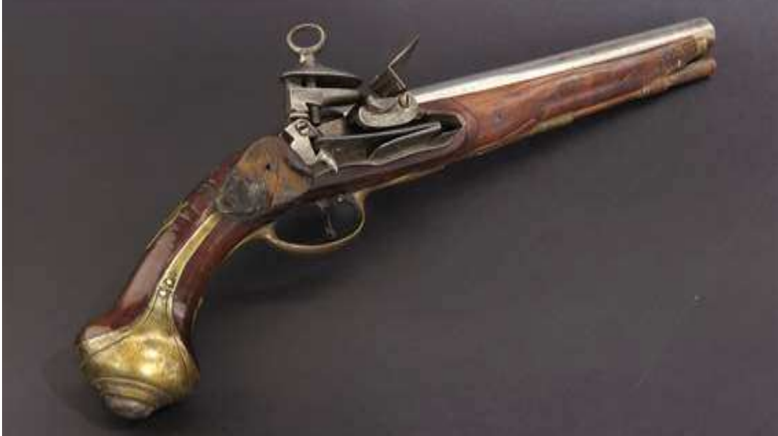
Pistola d'avantcarga amb pany de miquelet de la col·lecció del MNACTEC [c.1760-1790].
